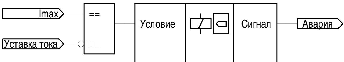
Рисунок 5. Структура блока защиты МТЗ
