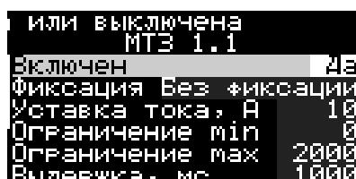
Рисунок 45. Перечень уставок и отображаемых параметров
