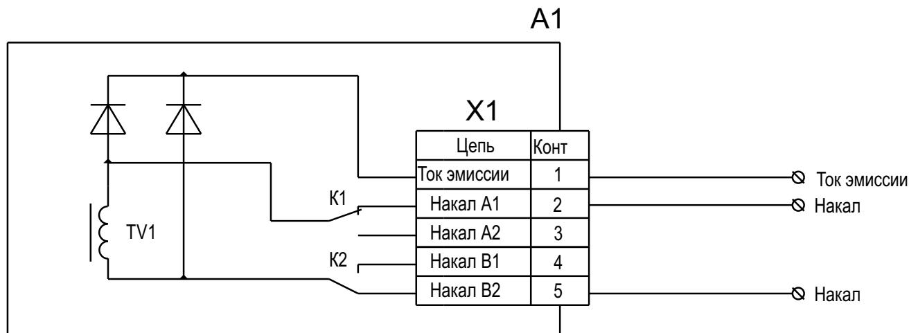
Рисунок 4. Подключение нагрузки накального канала для значения регистра «Номер накала» равного «3».
