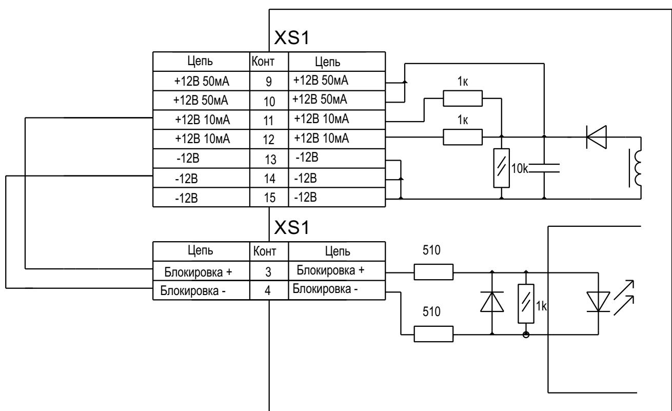
Рисунок 3. Подключение только цепи «Блокировка»
