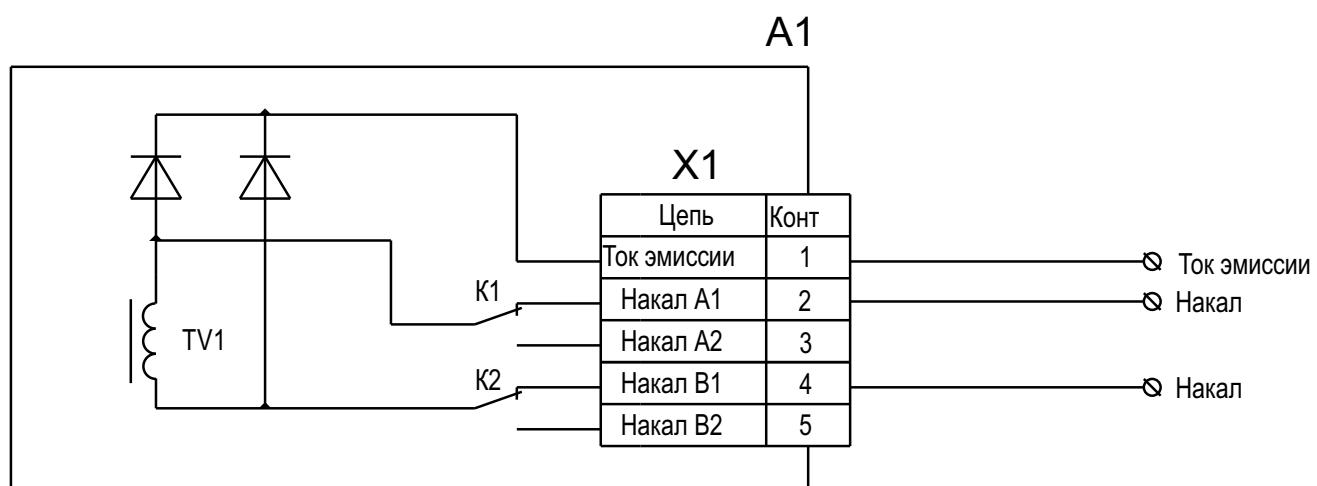
Рисунок 3. Подключение нагрузки накального канала для значения регистра «Номер накала» равного «2».
