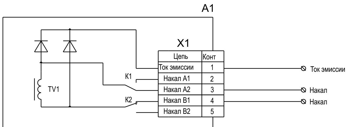
Рисунок 5. Подключение нагрузки накального канала для значения регистра «Номер накала» равного «4».
