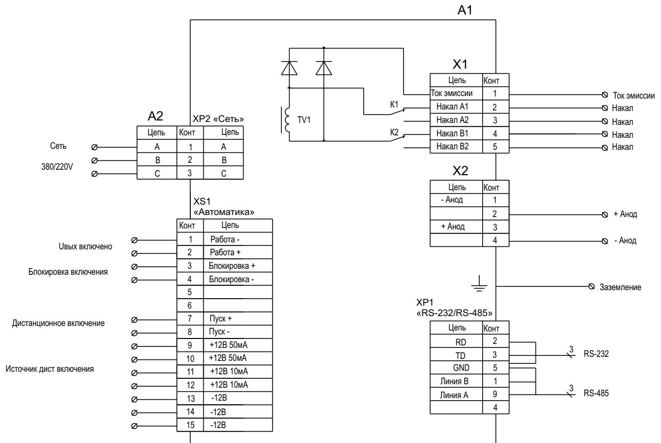
Рисунок 1. Подключение блока питания ALAPS-3-P-I-U.
