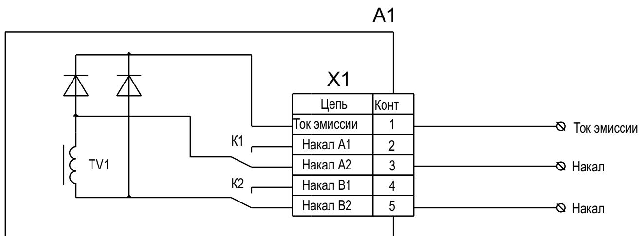
Рисунок 2. Подключение нагрузки накального канала для значения регистра «Номер накала» равного «1».
