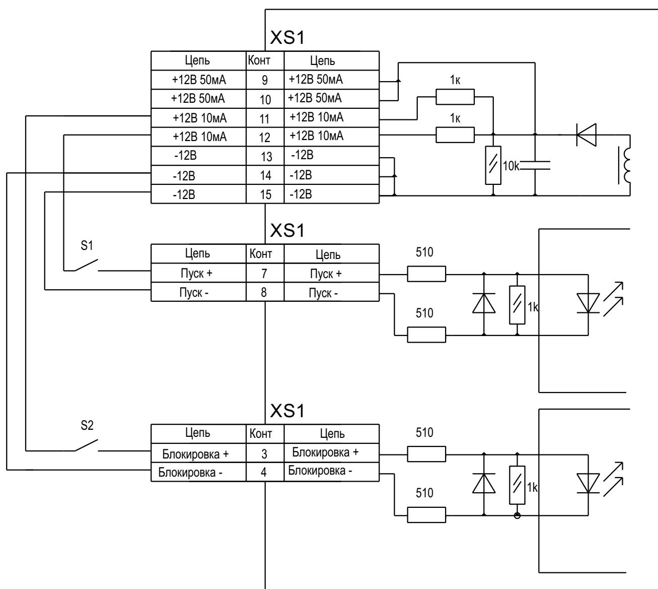
Рисунок 2. Подключение с внутренним источником напряжения.
