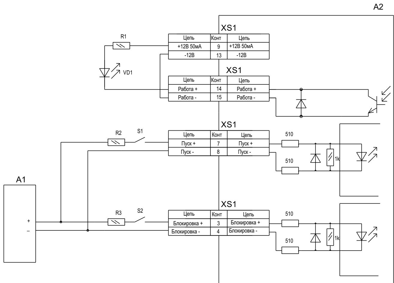
Рисунок 1. Подключение с внешним источником напряжения.
