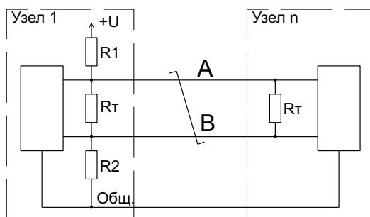
Рисунок 1. Подключение RS-485.
