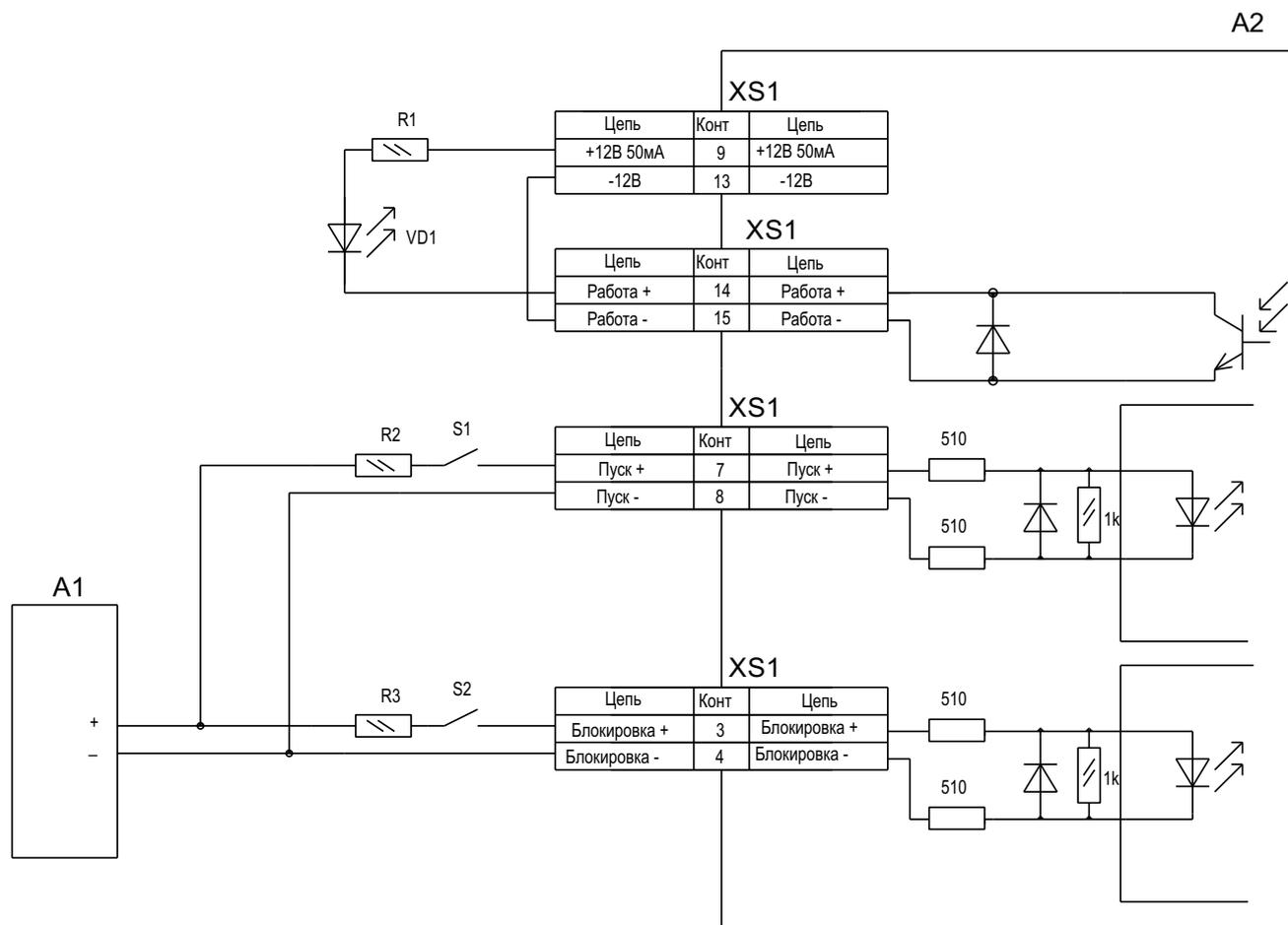
Рисунок 1. Подключение с внешним источником напряжения.
