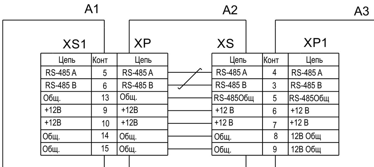
Рисунок 7. Схема электрическая подключения управления коммутатором SW от блока питания MPS-X-XX-XXX-XXXX-PC.
