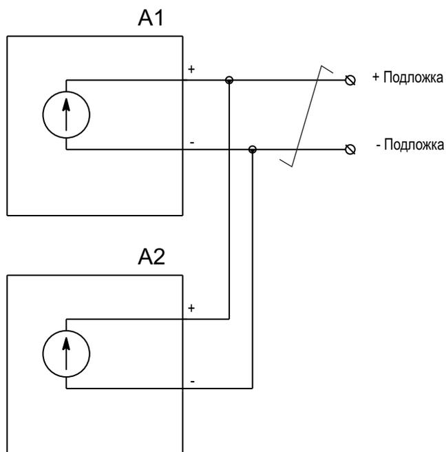
Рисунок 4. Подключение выходного напряжения блоков, работающих на общую нагрузку. A1 , A2 Блок питания MPS-X-XX-XXX-XXXX-PC.
