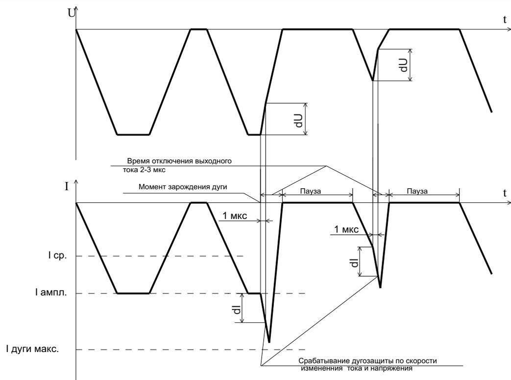
Рисунок 3. Работа активного дугогашения при срабатывании по параметрам «+dI для дуги» и «-dU для дуги».
