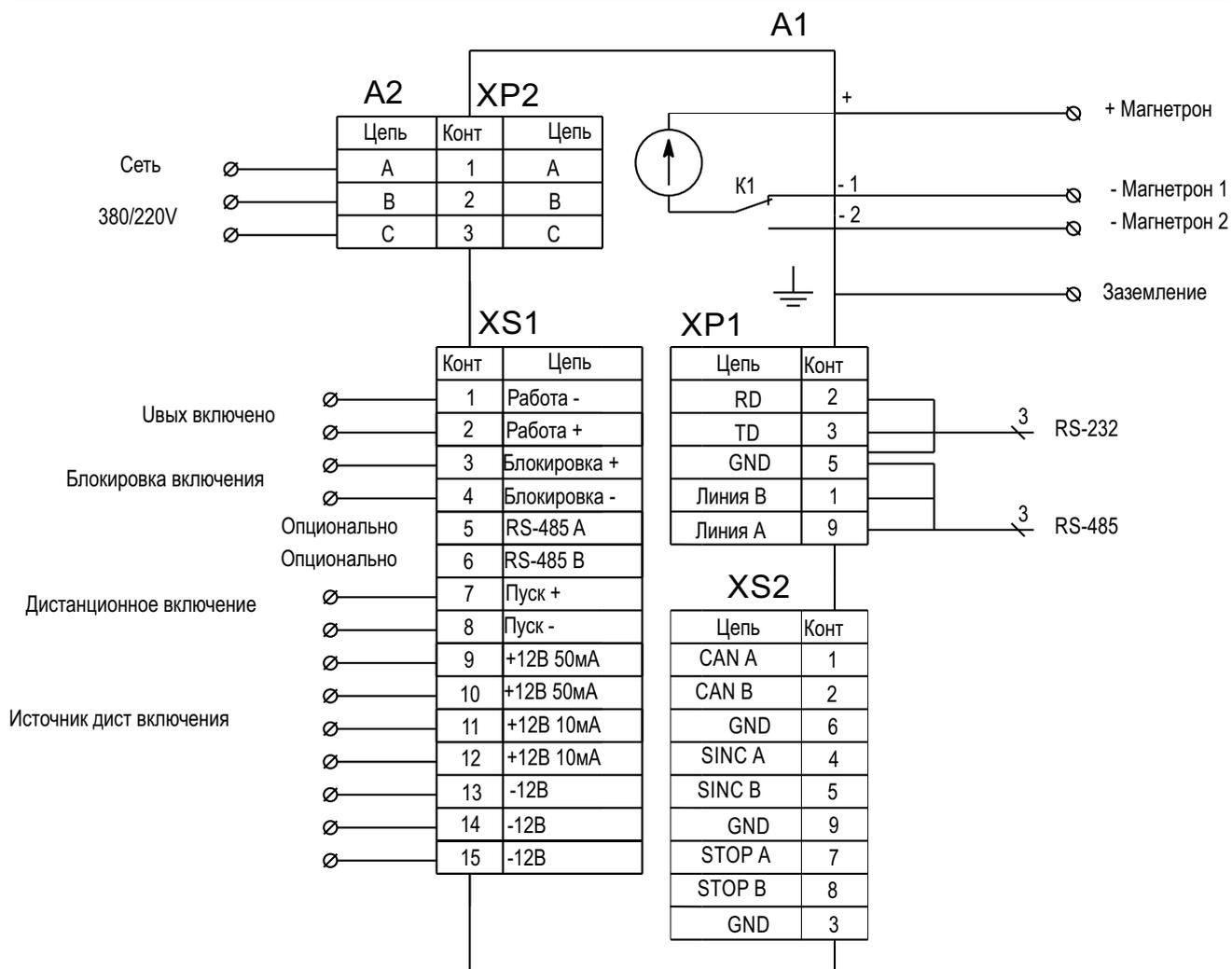
Рисунок 2. Подключение блока питания MPS-X-XX-XXX-XXXX-PCx2.
