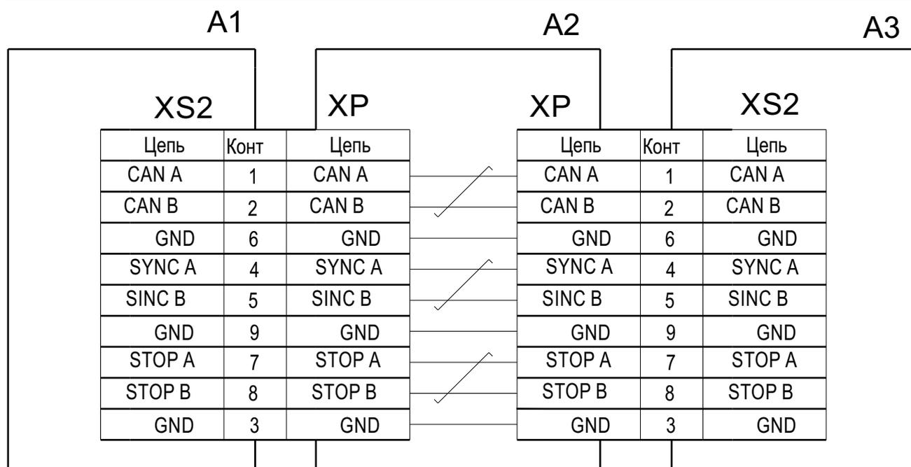
Рисунок 3. Схема электрическая подключения между блоками, работающими на общую нагрузку.
