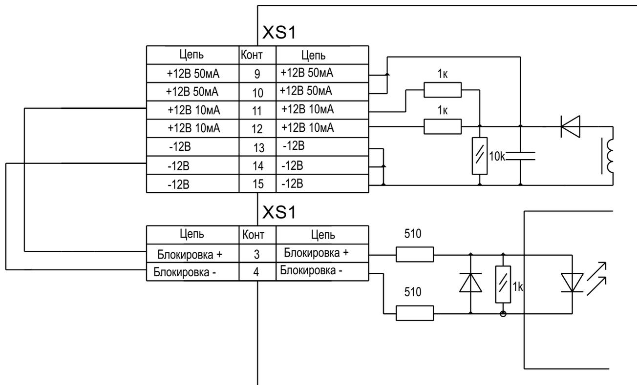
Рисунок 3. Подключение только цепи «Блокировка»
