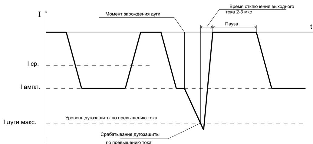
Рисунок 2. Работа активного дугогашения при срабатывании по параметру «Макс. ток дуги».
