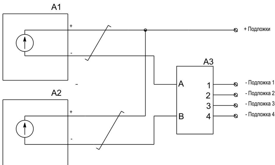
Рисунок 6. Подключение нагрузки к блоку питания через коммутатор SW-2x4.
