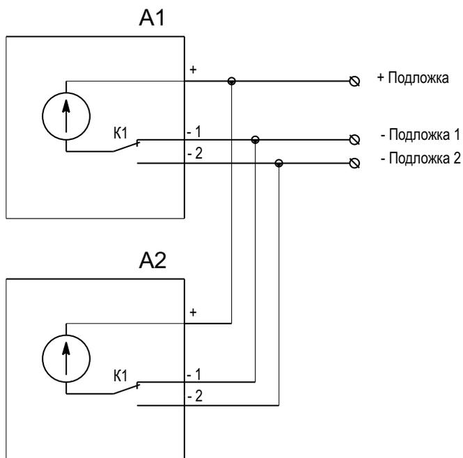
Рисунок 5. Подключение нагрузки к блоку питания MPS-X-XX-XXX-XXXX-PCx2.
