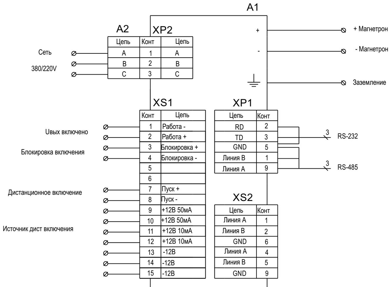
Рисунок 1. Подключение блока питания MPS-X-XX-XXX-XXXX-PC.
