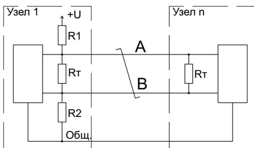
Рисунок 1. Подключение RS-485.
