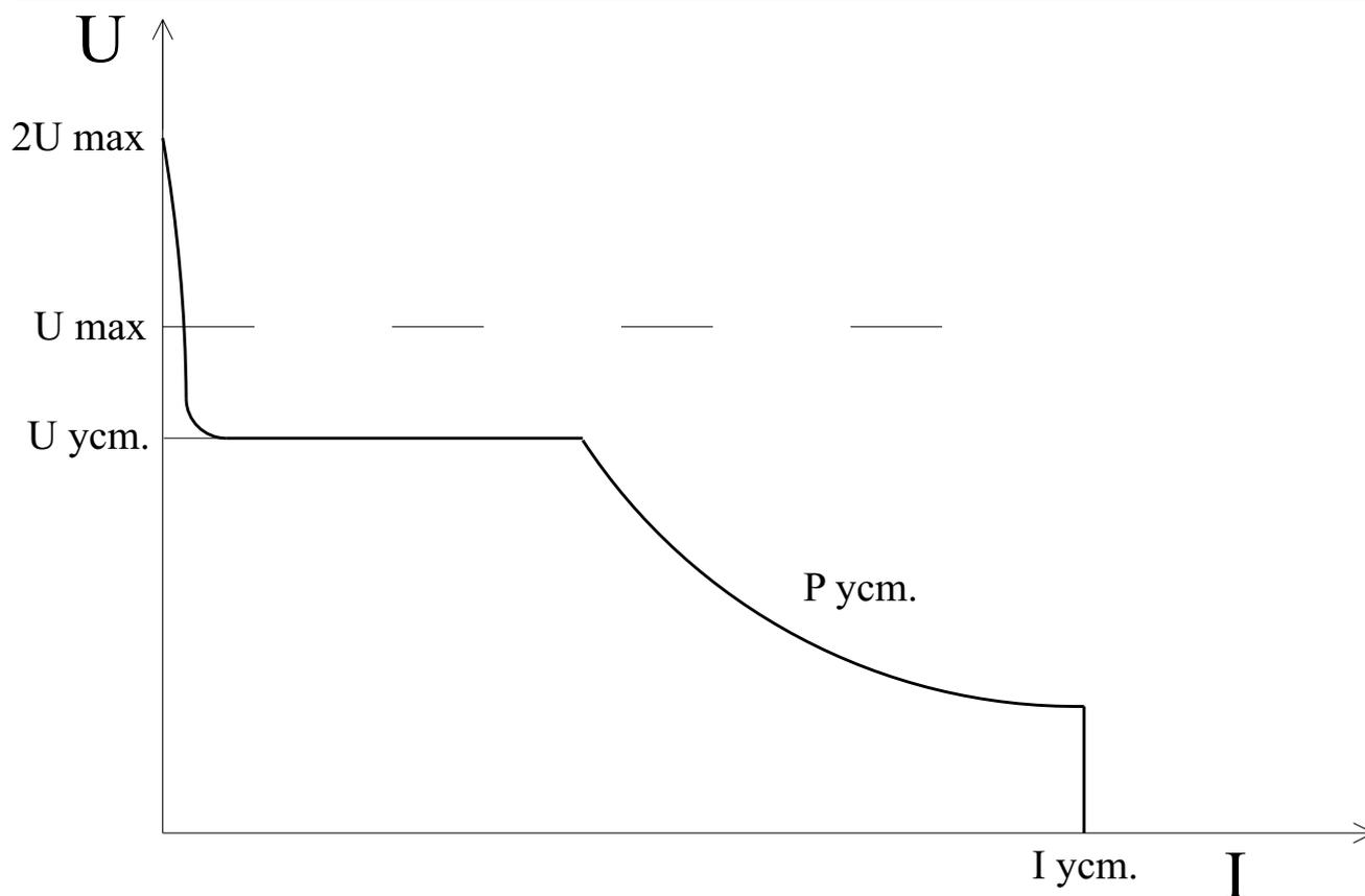
Рисунок 1. Вольт-амперная характеристика блока питания.
