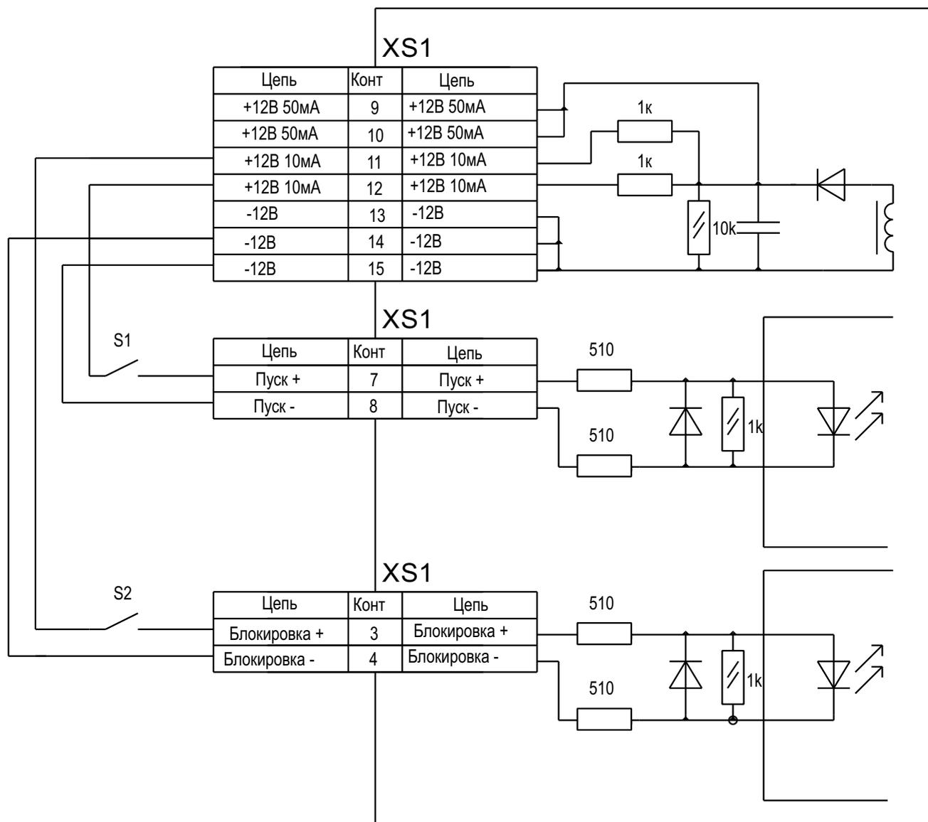
Рисунок 2. Подключение с внутренним источником напряжения.
