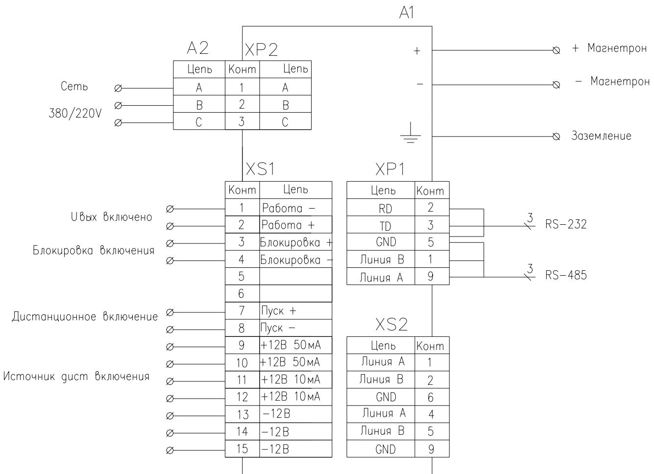
Схема электрическая подключения связи между блоками, работающими на общую нагрузку.
