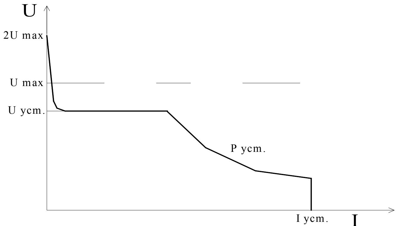
Рисунок 1. Вольт-амперная характеристика блока питания.
